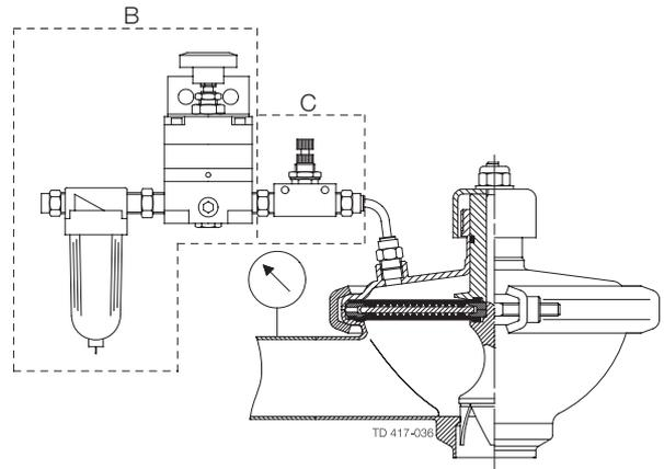
Fig. 3. CPMI-2 avec vanne de réglage de pression et capteur de pression.
