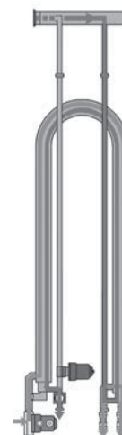
Fig 2. Mode refroidissement : La vanne d'eau de refroidissement s'ouvre. La vanne de remise en circulation est fermée et le produit s'écoule dans la direction opposée. L'eau froide est disponible en quelques secondes.
